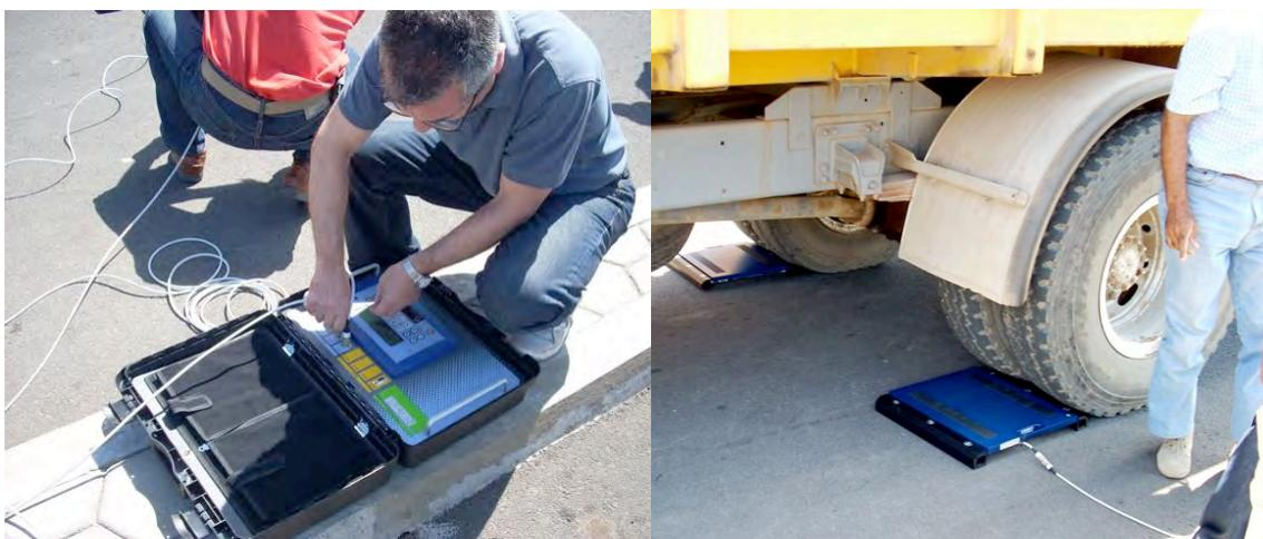
Esta báscula adquirida en España nos permitió realizar en la campaña de primavera, las pesadas de los camiones con carga y en vacío con una precisión de  $\pm 5$  kg, lo que agilizó y perfeccionó el sistema de pesaje de los residuos generados.
