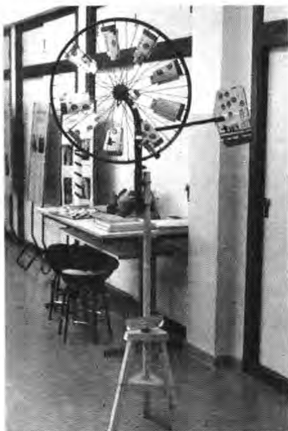
Aerogenerador "de bolsillo", hecho con una rueda de bicicleta, en la Exposición Itinerante de la Comarca de Pamplona
