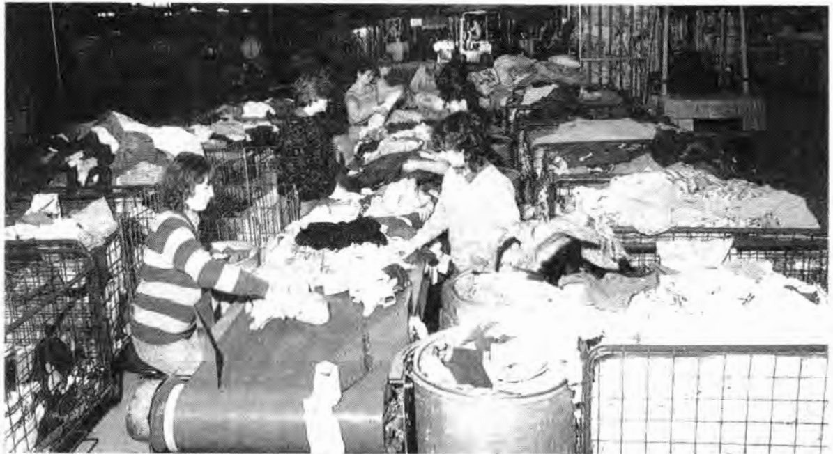
Clasificación y deshilachadora que permite reciclar el 25% de lo recogido en nuevo tejido o aislante térmico (fotos: Le transformeur. ANRED)
