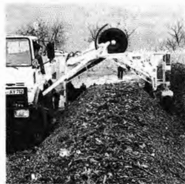
Elaboración de compost en la RFA, de basuras procedentes de la recogida selectiva según el método Biotonne. Arriba a la izquierda trituradora en funcionamiento. A la derecha máquina volteadora móvil remolcada por un camión, que es compartida por varias poblaciones. Cambia de posición los materiales dentro del montón de compost, colocando las capas más exteriores en el interior y viceversa, para lograr la fermentación completa. Foto central, otra vista de esta útil máquina. Abajo, instalación cubierta de fermentación de este tipo de compost, en Witzzenhausen. Fotos: Müll Fehr (central: CEPA).
