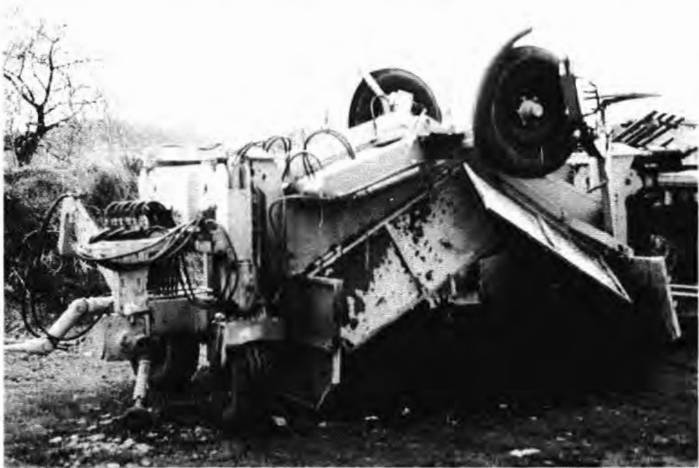
Elaboración de compost en la RFA, de basuras procedentes de la recogida selectiva según el método Biotonne. Arriba a la izquierda trituradora en funcionamiento. A la derecha máquina volteadora móvil remolcada por un camión, que es compartida por varias poblaciones. Cambia de posición los materiales dentro del montón de compost, colocando las capas más exteriores en el interior y viceversa, para lograr la fermentación completa. Foto central, otra vista de esta útil máquina. Abajo, instalación cubierta de fermentación de este tipo de compost, en Witzzenhausen. Fotos: Müll Fehr (central: CEPA).
