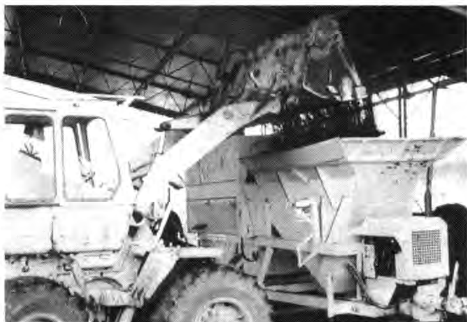
Trituradora para la confección de compost en las instalaciones de Witzenhausen, población cercana a Kassel, en Alemania. La materia orgánica procede de la recogida selectiva doméstica realizada según el modelo Biotonne que se describe en el último capítulo de este libro. Foto: CEPA.
