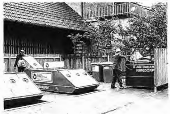
Contenedores de vidrio semienterrados para facilitar su acceso, aluminio y latas de conservas con prensa manual en Burgdorf, Suiza.
