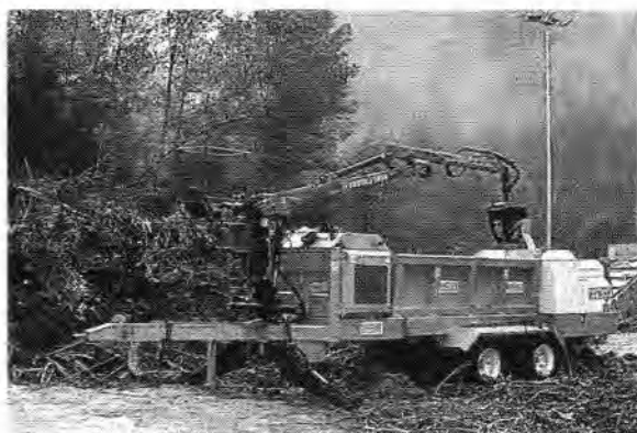
Arriba "Deixalleria" municipal de Torrelles de Llobregat (Barcelona) en 1995. Abajo, planta de compostaje de la misma población en 1997 (izda. trituradora-astilladora, dcha. elaboración de compost de la materia orgánica de recogida selectiva de las viviendas, con pureza superior al 99 %).
